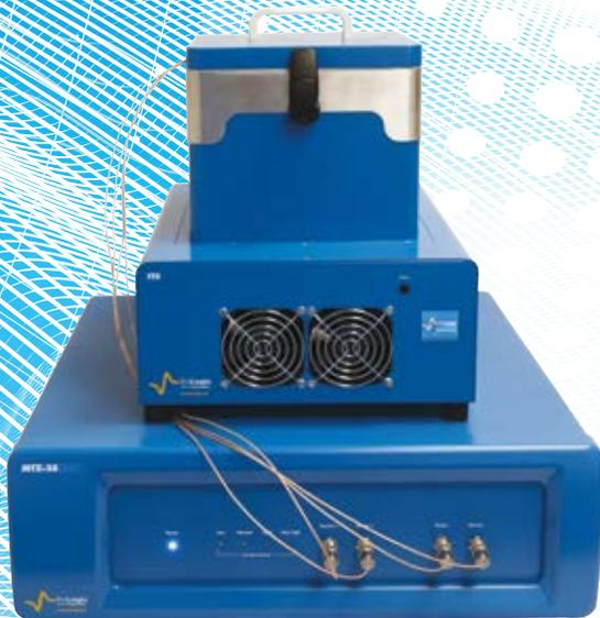
**Система измерения промежуточной температуры (ITS)** представляет собой блок регулирования температуры, основанный на эффекте Пельтье.
